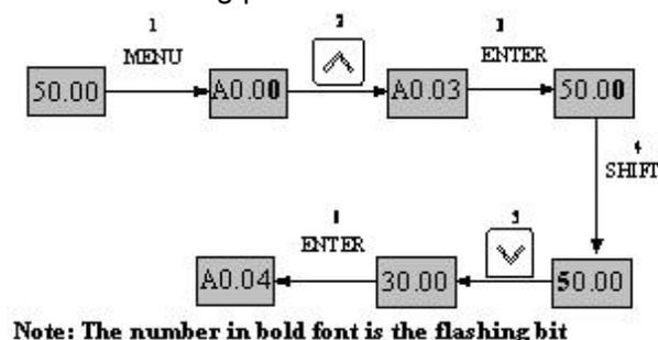
Fig 5-2 Example of setting parameter
